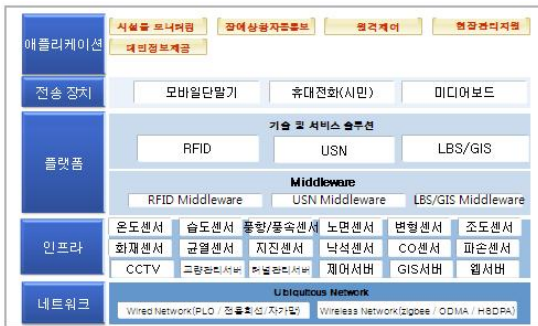
그림 8. 교통시설물관리 서비스 프레임워크 Fig. 8. Service Framework of Traffic Facility Management
