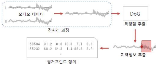
그림 6. 핑거프린트 추출과정 Fig. 6. Fingerprint extraction process
