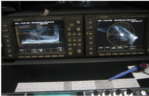
그림 6. 뉴스앵커의 카메라 출력에 대한 파형측정기와 벡터측정기의 측정값
