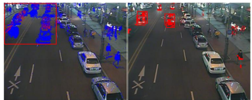
(a) 화소 상태 분석법 (b) 제안하는 방법 (a) Pixel state analysis (b) Proposed method 그림 17. 야간 영상 검출 실험 Fig. 17. Experimental result of the vehicle detection on an evening image.
