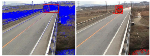
(c) 화소 상태 분석법 (d) 제안하는 기법 (c) Pixel state analysis (d) Proposed method 그림 15. 불안정한 조명 환경에서의 차량 검출 결과 Fig. 15. Experimental result of the vehicle detection on an unstable illumination.
