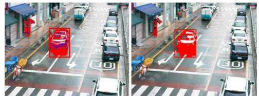
(a) 화소 상태 분석법 (b) 제안하는 기법 (a) Pixel state analysis (b) Proposed method 그림 16. 우천 시, 검출 실험 결과 Fig. 16. Experimental result of the vehicle detection on a rainy image.
