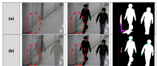
배경영상(왼쪽), 입력영상(가운데), 차영상결과(오른쪽) 그림 5. 객체 검출 결과
