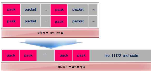
그림 7. 비디오 재구성 방법 Fig 7. Video reconstruction method
