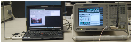
그림 8 . AMTV 송출기/모니터링 시스템 연결화면 Fig. 8. Connect AMTV transmitter with Monitoring System
