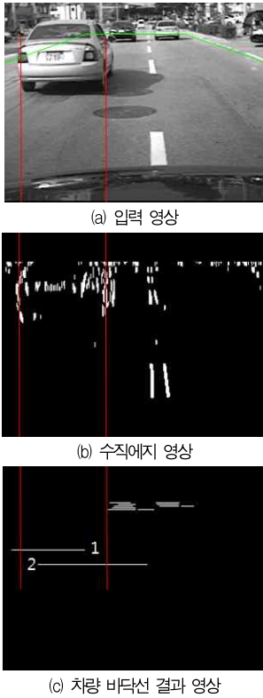
그림 9. 부정확한 차량 바닥선의 예. Fig. 9 An example of inaccurate vehicle bottom line.
