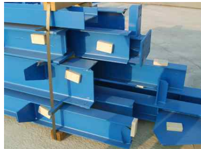
그림 8. 철강에 태그부착 모습 Fig. 8. Tag-attached to Steel
