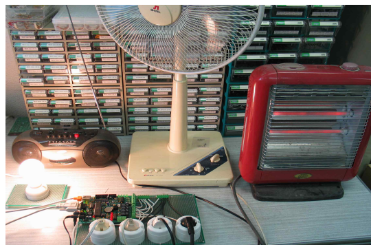
그림 13. 인터넷 전원 콘센트의 현장 테스트 Fig. 13. Field test of Internet Outlet
