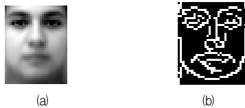
그림 6. (a)평균 얼굴영상 (b)Canny Edge 결과 Fig. 6. (a)Average face image (b)Canny Edge of (a)
