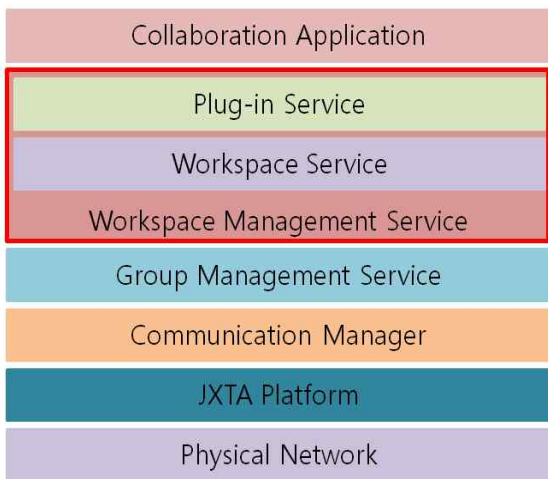
그림 20. 작업장 관리 서비스를 포함하는 PECOLE+ 계층 구조 Fig 20. PECOLE+ Hierarchical Structure with Workspace Management Service
