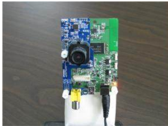
그림 1. CCD 카메라 모듈 Fig. 1. CCD Camera Module
