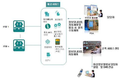
그림 7. 스마트폰을 이용한 원격 건물관리 시스템구성 Fig 7. Configuration of Remote Building Management System Using Smart Phone
