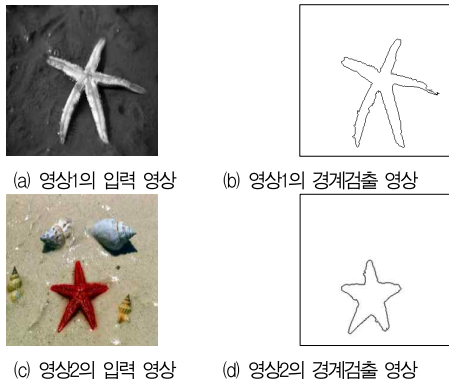
그림 20. 경계 검출 결과 영상 1 Fig. 20. Result of edge detection
