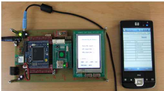
그림 9. 제안한 고장예측 알고리즘용 테스트베드 시스템 Fig. 9. A testbed system for the proposed fault prediction algorithm
