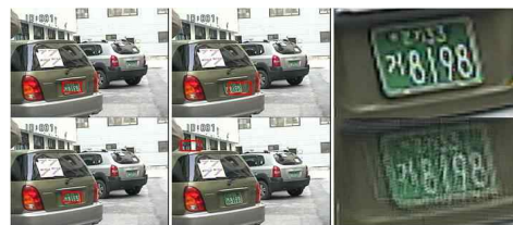
그림 10. 위치기반 후처리 적용 결과 비교 Fig. 10. Reconstruction results of (a) with post processing and (b) without using post processing.
