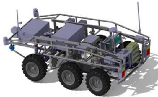
그림 5. 무인 지상로봇의 형상 Fig. 5. Appearance of unmanned ground vehicle
