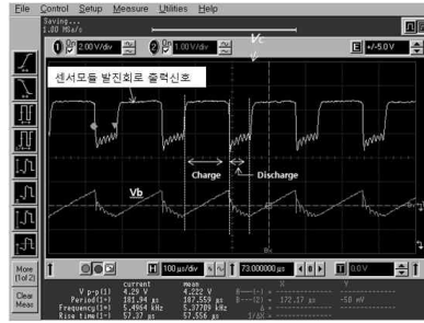
그림 7. 센서 발진회로의 출력 신호 v o Fig. 7. Output signal v o of sensor oscillation circuit
