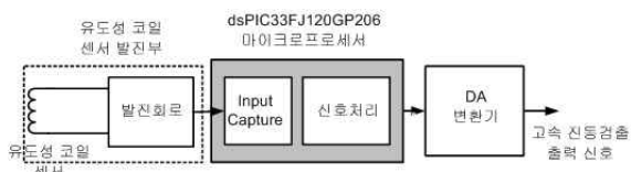
그림 2. 진동검출을 위한 유도성 근접 센서 모듈 구성도 Fig. 2. Block diagram of inductive proximity sensor module for vibration detect
