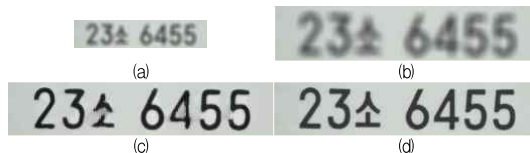
그림 7. 인공적으로 열화시킨 신형 번호판 복원영상 (a) 열화된 저해상도 영상 (b) 정방형 보간법 (c) 제안한 방법 (d) 원본 영상
