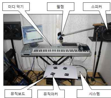
그림 10. 제안 시스템의 하드웨어 구성 Fig 10. Hardware Configuration of the Proposed System
