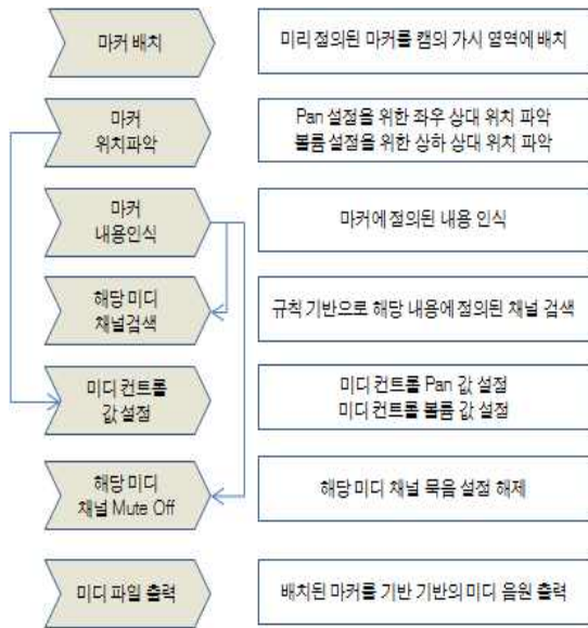
그림 11. 시스템 흐름도 Fig 11. System FlowChart
