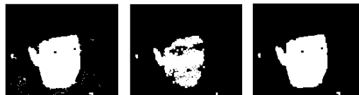
(a) 웨이블릿 closing (b) 웨이블릿 opening (c) 웨이블릿 OC (a) Wavelet closing (b) Wavelet opening (c) Wavelet OC 그림 5. 웨이블릿 형태학 연산자를 적용한 결과 영상 Fig. 5. Result images applying wavelet morphology operators
