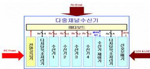
그림 1. 다중채널 수신기 구성도 Fig. 1. Configuration of multi-channel receiver
