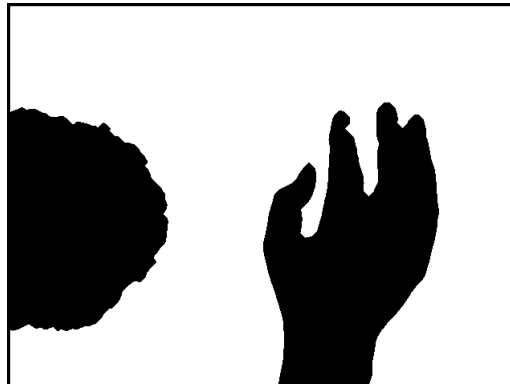
그림 6. 색상 정보로 이진화된 영상 Fig. 6. A binarized image using hue distribution
