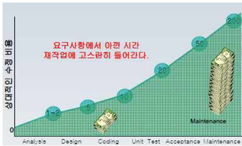
그림 1. 요구사항 에러 발견된 단계별 비용 Fig. 1.Step-by-step cost of requirements errors found
