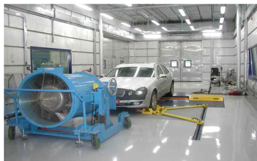
그림 1. 차시 다이내모미터에서의 배기가스 테스트 Fig. 1. Emission gas test in the chassis dynamometer.
