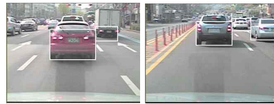
(c) 제안하는 방법을 이용한 차량 검출 그림 11. 기존 방법과 제안한 방법을 이용한 차량 검출 결과 Fig. 11. Vehicle detection result between previous method and proposed method
