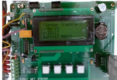
그림 9. 제어보드와 LCD Display Fig. 9. Control Board and LCD Display
