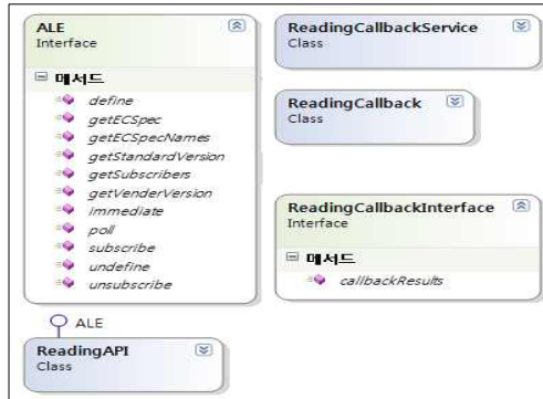
그림 6. 클라이언트 측 읽기 서비스 클래스 다이어그램 Fig. 6. Class Diagram of Reading Service on Client
