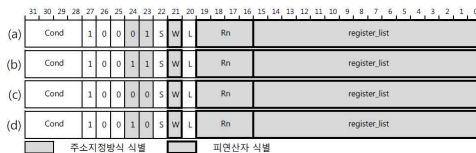
그림 8. 주소지정 방식 4의 형식 Fig. 8. Formats of addressing mode 4
