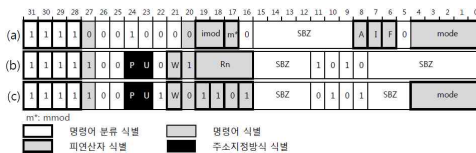
그림 9. 예외 처리 명령어의 형식 Fig. 9. Formats of exception processing instructions
