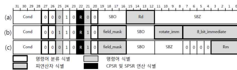
그림 4. 상태 레지스터 접근 명령어의 형식 Fig. 4. Formats of status register access instructions
