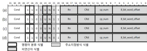
그림 11. 주소지정 방식 5의 형식 Fig. 11. Formats of addressing mode 5
