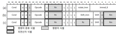
그림 3. 데이터 처리 명령어와 주소지정 방식의 형식 Fig. 3. Formats of data-processing instructions and addressing mode1
