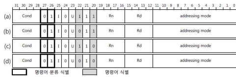
그림 5. 변환 로드/스토어 명령어의 형식 Fig. 5. Formats of load and store with translation instructions
