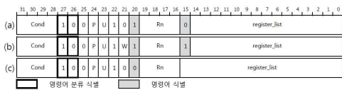
그림 7. 다중 로드/스토어 명령어의 형식 Fig. 7. Formats of load and store multiple instructions
