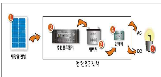
그림 3. 태양에너지를 이용한 전원공급시스템의 구성 Fig. 3. Construct of Power Supply System using the Solar Energy
