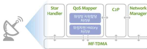
그림 11. 제안하는 네트워크 제어기 구조 Fig. 11. Proposing Network Controller Architecture
