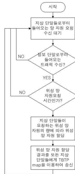
그림 10. 기존 네트워크 제어기 구조 Fig. 10. Before Network Controller Architecture
