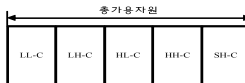
그림 3. 다중 세션을 위한 자원 할당 구조 Fig. 3. Resource allocation for multiple session
