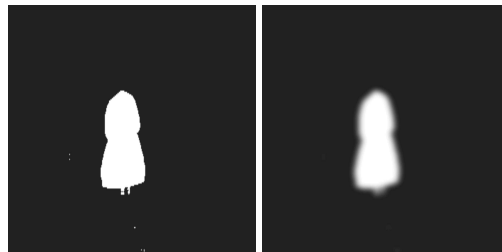
그림 7. Gaussian Filter를 적용한 Smooth the depth image Fig. 7. Smooth the depth image with Gaussian Filter
