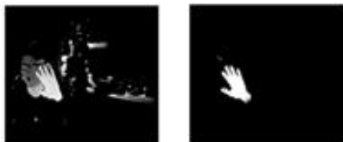
(a) 피부색 영역 검출 (b) 손 검출 그림 9. 피부색 영역 검출로부터 거리 정보를 이용한 손 검출 (a)피부색 영역 검출결과 (b) 손 검출 결과
