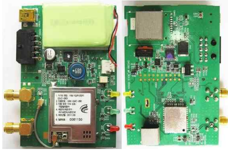
그림 4. 개발된 GPS 단말기 실물 모습전·후면 Fig. 4. Photos of the Developed GPS Terminal
