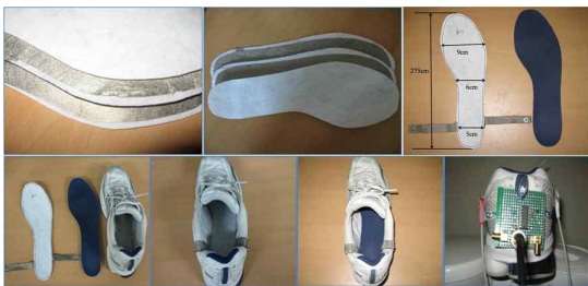
그림 2 제작된 센서 및 측정회로 장착 모습 Fig. 2. Fabricated Sensor and Measurement Circuit
