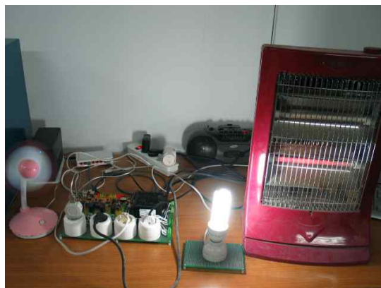
그림 10. 인터넷 전원콘센트의 현장 시험 Fig. 10. Field test of Internet Outlet
