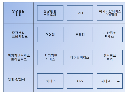
그림 3. 제안시스템 플랫폼구조 Fig. 3. Platform Architecture of Proposed System
