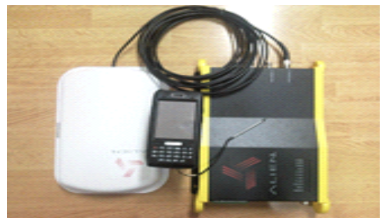
그림 2. RFID 리더 및 안테나 Fig. 2. RFID Reader and Antenna
