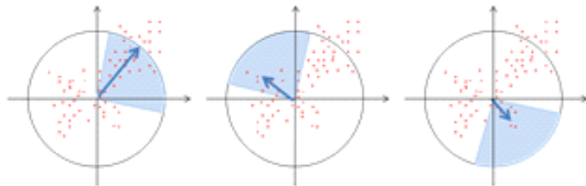
그림 2. \pi / 2 크기의 방향 윈도우 Fig.2. Orientation window with size of \pi / 2
