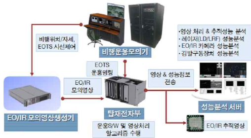
그림 16. EOTS HILS 인터페이스 및 활용방안 Fig. 16. EOTS HILS Interface & Application
