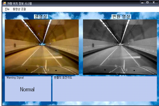
그림 2. 입력 주행 영상과 그레이 변환 영상 Fig. 2. Input Navigational Image and Its Gray-scale Image
