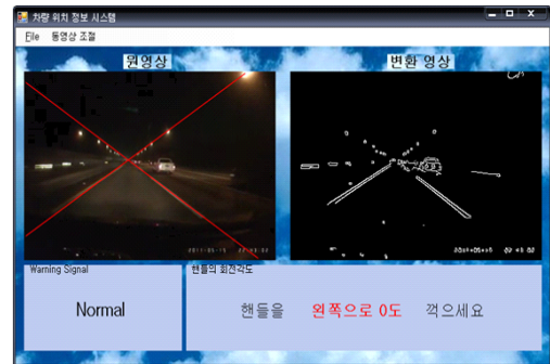
그림 8. 허프 변환을 이용한 주행 경로 검출(야간 주행) Fig. 8. Navigational Path Detection Using Hough Transform(Night Navigation)
