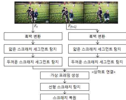
그림 3. 스크래치 탐지 과정 Fig. 3. Scratch Detection Process
