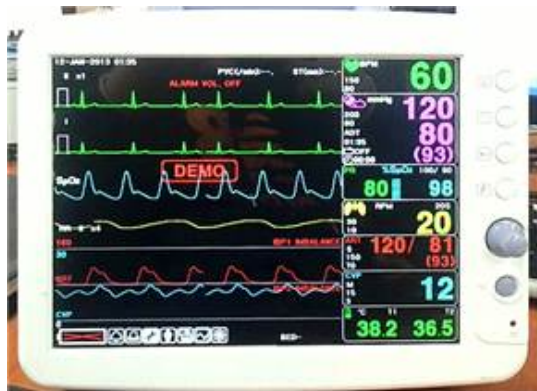
그림 7. LCD GUI가 출력된 전면 패널 Fig. 7. Front panel with LCD GUI
