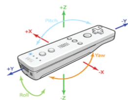
그림 4. 닌텐도 Wii 리모트 외형 (15) Fig. 4. Nintendo Wii Remote
