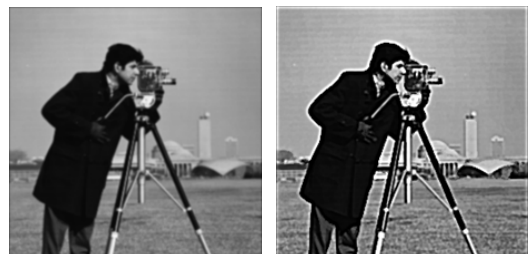
(a) 번짐 영상 Blur Image (b) 제안하는 방법의 결과 Result of Proposed Method
