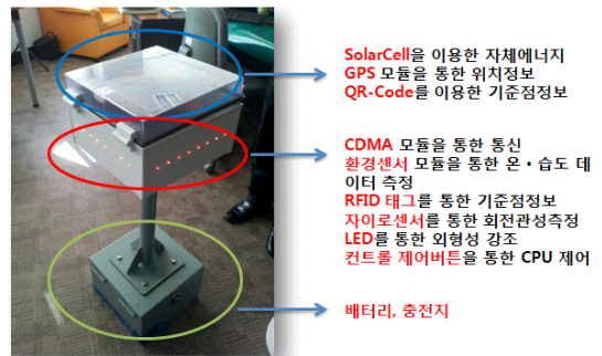
그림 18. 다기능 전자 측량기준점 H/W Fig. 18. Multi Function Electronic Measurement Datum Point H/W
