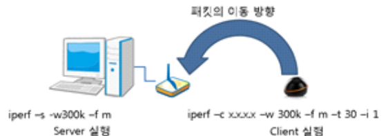
그림 1. Upload throughput 측정 시 구성 Fig. 1. Upload throughput test diagram
