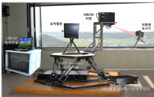
그림 16. 위협체모사기 야외 실거리 기만시험 Fig. 16. Infrared Surrogate System for Field Jamming Test
